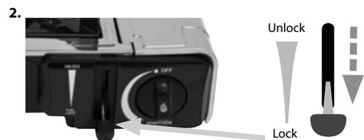
Nå som gassbeholderen er på plass, skyver du låsespaken ned inntil den er i låst posisjon.
