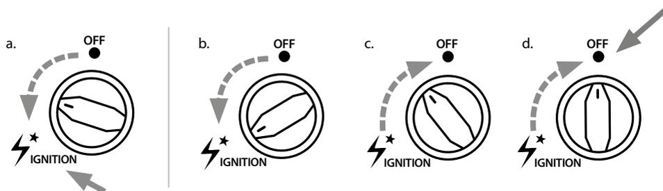
a.) Ontsteek de brander door de bedieningsknop tegen de wijzers van de klok in te draaien in de richting van IGNITION, totdat u een klik hoort.
