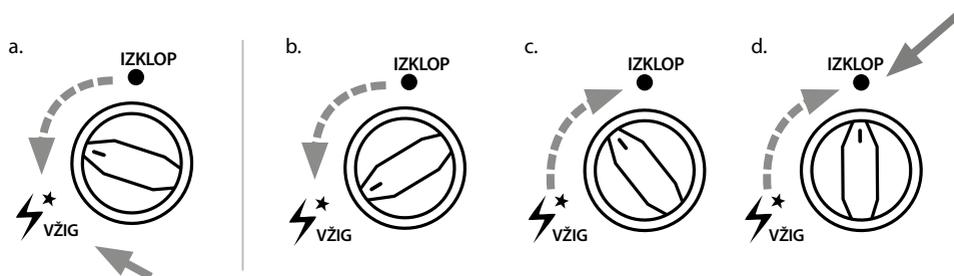
a.) Gorilnik vžgite tako, da vrtite krmilni gumb proti urinemu kazalcu v smeri IGNITION, dokler ne zaslišite klika. Klikanje je zvok vžiga in gorilnik se mora vžgati.
